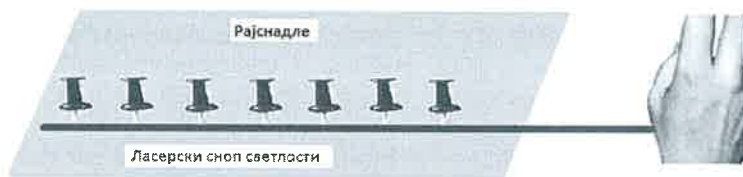
СЛИКА 7. Обележавање правца простирања светлости ради демонстрације праволијског простирања у хомогеној средини, помоћу рајснадла.
